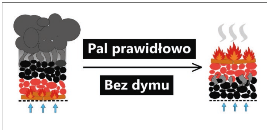
Rys. 2. Spalanie przeciwprądowe (z lewej) i współprądowe (z prawej)
